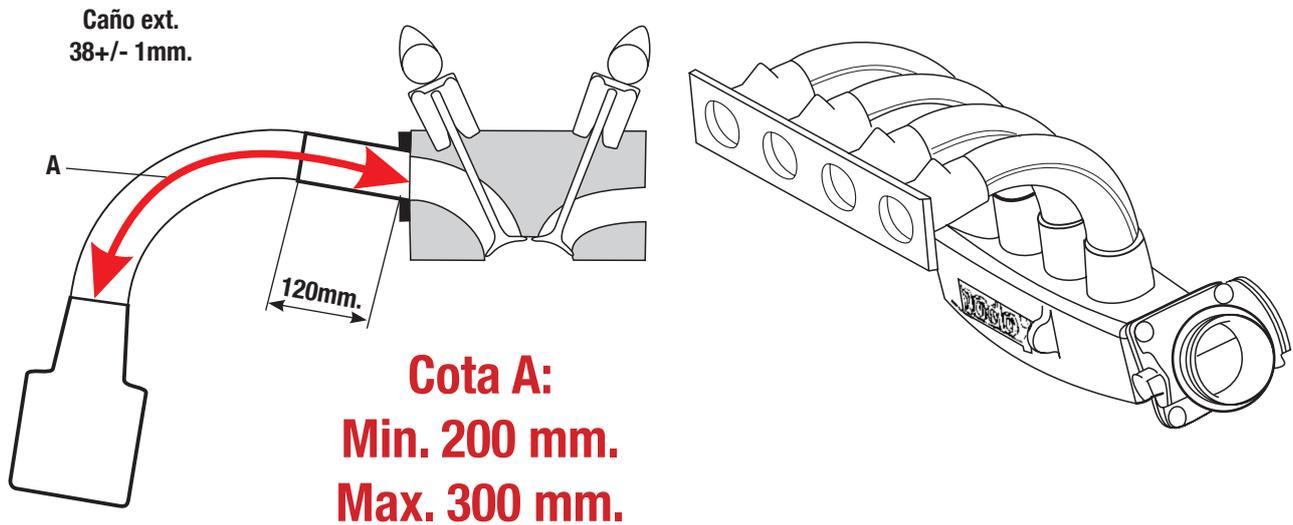
Múltiple de admisión, caja mariposa son homologadas por la categoría. Dentro de la cota A tiene 120 mm. de libre diseño luego de dicha medida el caño debe mantener su sección constante con su respectiva tolerancia. Se puede pulir la boca del plenum hasta un diámetro máximo de 61,5 mm. y con una profundidad máxima hasta el centro de la primera boca de admisión comenzando del apoyo de la caja mariposa.
