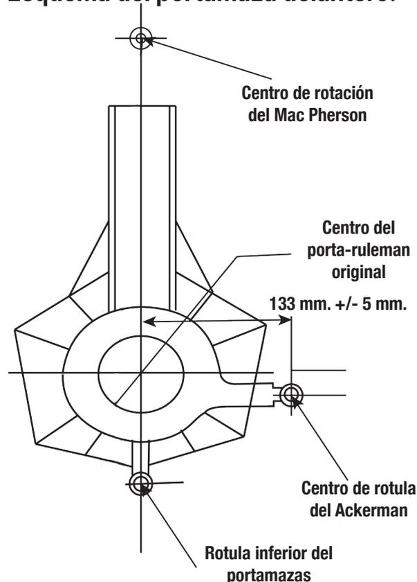
**Se permite reemplazar el rulemán original por otro de mayor diámetro, permitiéndose las modificaciones necesarias. Diámetro máximo exterior del rulemán hasta 116,00 mm.**
