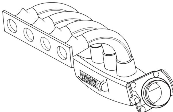
Múltiple de admisión, caja mariposa son homologadas por la categoría. Dentro de la cota A tiene 120 mm. de libre diseño luego de dicha medida el caño debe mantener su sección constante con su respectiva tolerancia. Se puede pulir la boca del plenum hasta un diámetro máximo de 61, 5 mm. y con una profundidad máxima hasta el centro de la primera boca de admisión comenzando del apoyo de la caja mariposa.
