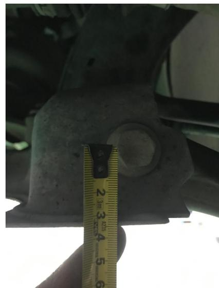
**Se permite reemplazar el rulemán original por otro de mayor diámetro, permitiéndose las modificaciones necesarias. Diámetro máximo exterior del rulemán hasta 116,00 mm.**
