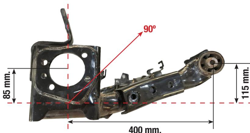
Se permite reemplazar el rulemán original por otro de mayor diámetro, permitiéndose las modificaciones necesarias. Diámetro máximo exterior del rulemán hasta 116,00 mm.
